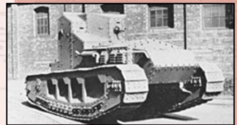
Drie foto's van een standaard productie Whippet, gemaakt bij de Foster fabriek in Lincoln. De schietpoorten en de kijkspleten zijn duidelijk te zien. De achterste opening in de zijkant van het onderstel is vervallen.
